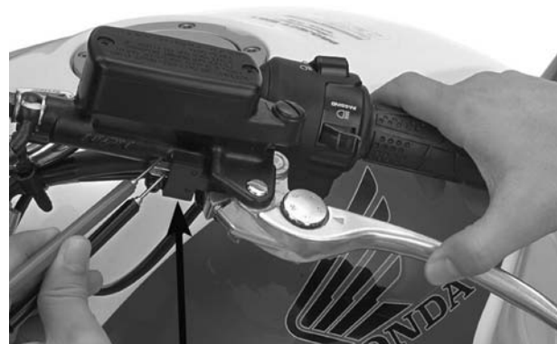
INTERRUPTOR DA EMBREAGEM INTERRUPTOR DE PONTO-MORTO
